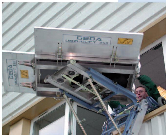
Le plateau pivotant se tourne de 90° devant la fenêtre et se glisse dans la chambre pour charger et décharger
